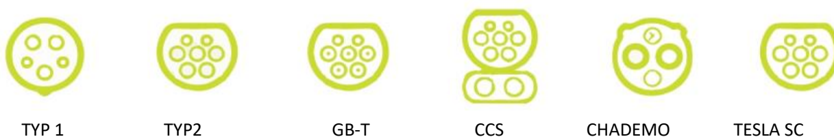
Rysunek 44 Rodzaje gniazd ładowania
